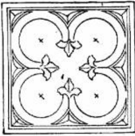
Kapitell eines Backstein-Pfeilers, oben in Konsolen mündend, als Auflager der Gewölbe-Gurtbögen.
